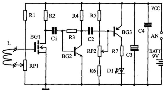
1. 一种电磁辐射检测装置由供电电源、滤波电路、电磁感应采样线圈、高灵敏初级放大电路、阻容二级放大电路、阻容三级放大电路和显示电路组成,其特征是电磁感应采样元件由电磁感应线圈(L)、场效应管组成初级放大电路,采样电磁感应线圈的两端分别接场效应管(BG1)的栅极和电位器(RP1)的中间抽头。
